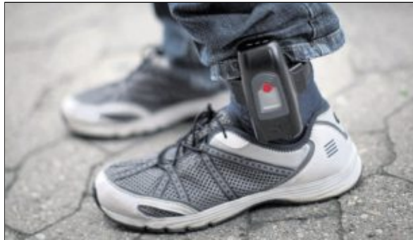
Eine elektronische Fußfessel wird über dem Knöchel am Bein getragen. Wird versucht, sie zu entfernen, oder verlässt der Träger einen bestimmten Radius, löst sie Alarm aus.
